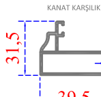
Sistem Kodu 41-2317 Ağırlık (kg/m) 0,555
